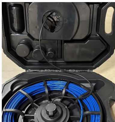
Fig. 49 : incorrect : le câble de la caméra n'est pas tendu
