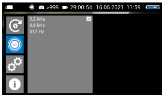
Fig. 32 : émetteur de localisation avec fréquence d'émission de 9,2 kHz sélectionnée
