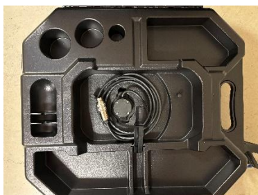
Fig. 50 : câble du moniteur dans la coque supérieure de la mallette
