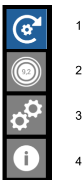
Fig.26: Menu système avec orientation de l'écran (1), localisation (2), réglages (3) et menu d'information (4)
