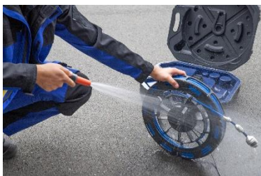
Fig.42: Nettoyage au jet d'eau du dévidoir et de la tige
