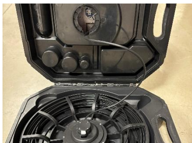
Fig.45 : incorrect : câble de la caméra non tendu
