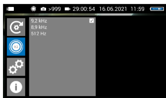
Fig.29: Émetteur de localisation avec fréquence d'émission de 9,2 kHz sélectionnée
