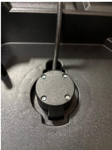
Fig.44: Insérez le câble de la caméra dans la coque supérieure et tirez-le délicatement pour le tendre
