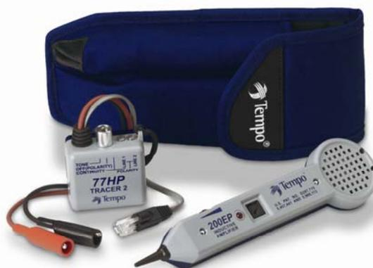
L'amplificateur inductif 200EP permet une identification sans contact direct avec le conducteur métallique. Il a été conçu pour être utilisé avec n'importe quel générateur de tonalité. Les particularités du 200EP sont entre autres : réglage de la tonalité très sensible - une fiche de sortie encastrée pour l'utilisation d'un casque ou d'un combiné - un interrupteur marche/arrêt pour éviter que les piles ne se déchargent - un embout plastique pour réduire les risques de court-circuit.
