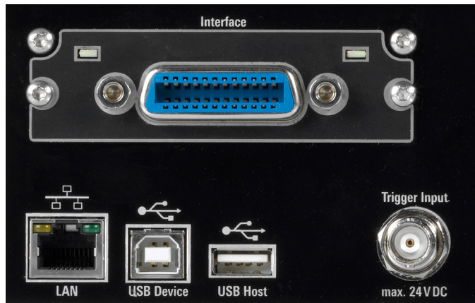
Toutes les interfaces de contrôle à distance sont disponibles sur le panneau arrière de l'instrument (exemple : R&S®LCX200 avec option IEEE-488 installée)
