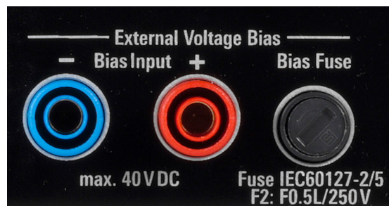
Ports dédiés aux tensions bias externes sur le panneau arrière
