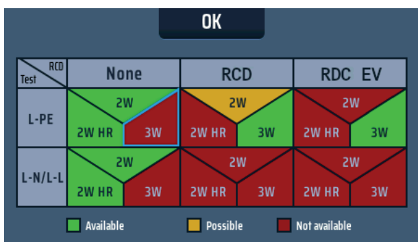
Fig. 54 : Tableau de recommandations des tests de boucle
