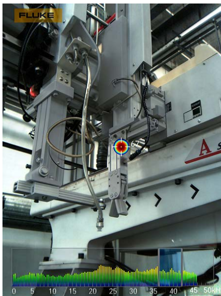
Détection de fuites d'air comprimé dans des machines industrielles
