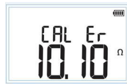
Figure 2. Ecran d'erreur d'étalonnage
