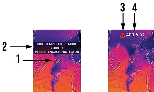
**Figure 13.2** 1. Point ciblé, 2. Message d'alerte, 3. L'icône « H » s'affiche lorsque l'interrupteur est engagé, 4. Mesure de la température.
