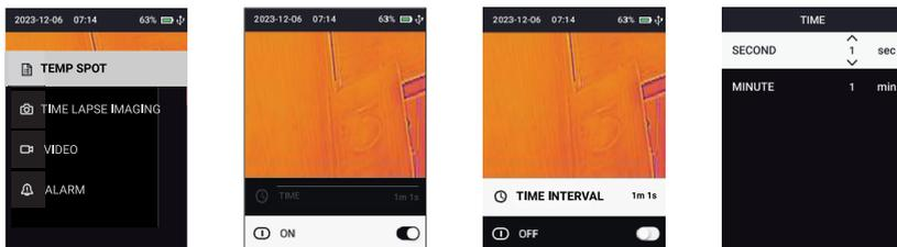
**Figure 11.13** Configuration de la fonction d'enregistrement des données de POINT DE TEMPÉRATURE.
