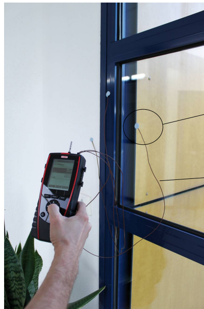
Fixation de la sonde filaire sur la paroi-fenêtre
