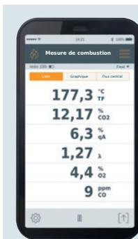
Tant l'utilisation de l'appareil de mesure que l'affichage des valeurs de mesure se font via Bluetooth sur Smartphone / tablette, grâce à l'App testo 330i – indépendamment du lieu de mesure. Vous pouvez en outre établir des rapports de mesure dans l'App, y ajouter des photos et commentaires et les envoyer par e-mail. Pour iOS et Android.
