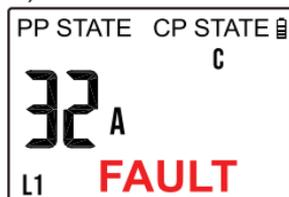
2. Si **FAULT** s'affiche, le disjoncteur du système de chargeur ne s'est pas enclenché et doit donc être réparé.
