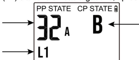
REMARQUE : Si vous effectuez un PRÉTEST PE avec l'EV45 débranché du chargeur, le test réussit, mais l'état du pilote de commande affiche **E** (Erreur).
