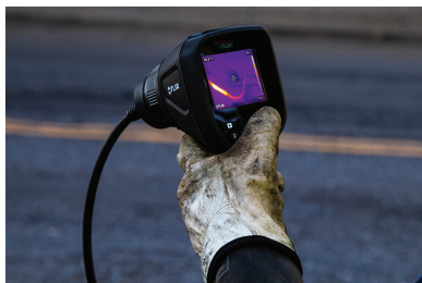
Figure 8.2 Visualisez la zone de test sur l'écran du VS290-00.
