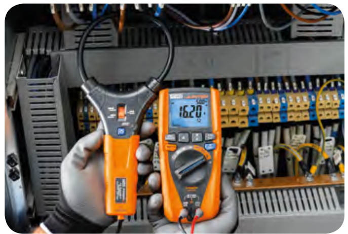
Mesure de courant AC avec transducteur flexible F3000U.
