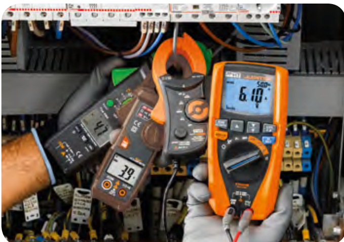
Comparatif entre pinces 3.9A: pince de valeur moyenne - 4.7A: pince TRMS 6.1A: lecture correct AC+DC TRMS.
