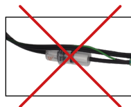
Mauvaise position du pot à condensat
