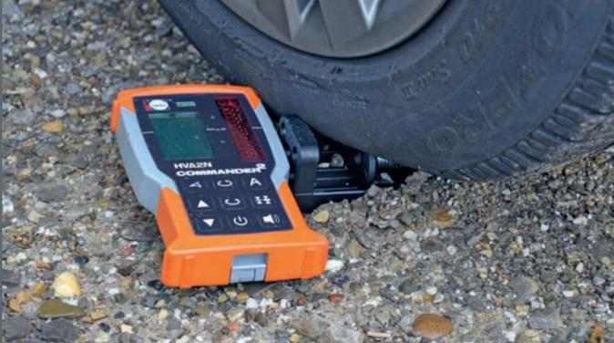
Les récepteurs laser **ACCEPTOR<sup>pro+</sup>** et **COMMANDER<sup>2</sup>** sont équipés de série du support de récepteur Heavy-Duty en aluminium moulé sous pression qui est pratiquement indestructible.
