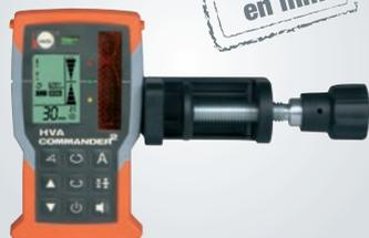
Pour les applications avec chevalet pour tirer au cordeau ou de construction de façades, la fonction AutoAlign permet un gain de temps considérable car le pointage manuel fastidieux du plan du laser sur le récepteur laser est supprimé. Les adaptateurs pour chevalet pour tirer au cordeau ou la construction de façades prévus pour le **PRIMUS 2** et le récepteur laser **COMMANDER 2** sont des accessoires disponibles en option.
