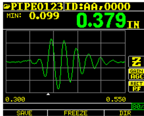
Signal RF avec curseur renversé « V » indiquant l'endroit où la prise de mesures est en cours
