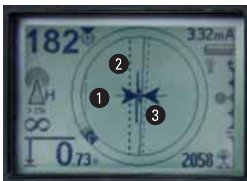
Ecran en mode Omniseek : Affiche plusieurs lignes (instantané de trois lignes différentes) ① , ② , ③
