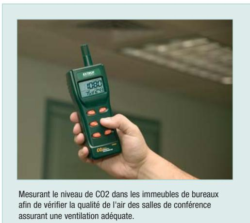
Mesurant le niveau de CO2 dans les immeubles de bureaux afin de vérifier la qualité de l'air des salles de conférence assurant une ventilation adéquate.
