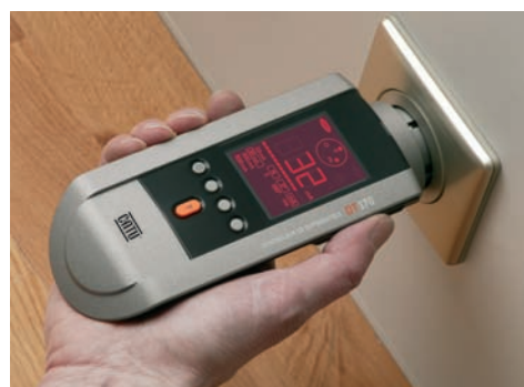
Fig. 2 : affichage d'une valeur incorrecte en valeur de courant (exemple : 32mA pour un DDR de 30mA)
