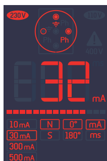
Exemple d'affichage d'une valeur incorrecte > à 30mA
