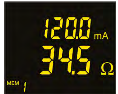
Mode standard : Impédance et courant de fuite
