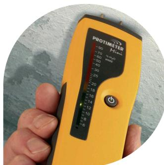
Une fois les pointes de l'Humitest® Mini® enfoncées dans le matériau solide non conducteur, le taux d'humidité du bois équivalente s'affiche sur l'échelle de 60 diodes lumineuses.
