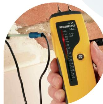
Les sondes longues isolées (accessoire en option) permettent de réaliser des mesures en profondeur.
