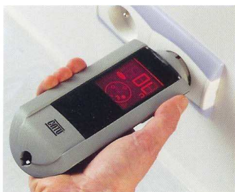
Exemple d'affichage en cas de terre absente et phase à gauche. OL = overload = valeur de terre très élevée.
