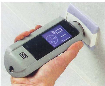
Exemple d'affichage d'une installation conforme : réseau 230 V, phase à droite, valeur de terre < 100 Ω.
