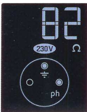
Exemple d'affichage d'une installation conforme : réseau 230 V, phase à droite, valeur de terre < 100 Ω.
