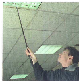
Contrôle de continuité sur plafonnier avec perchette de contact longueur 0,8 m (réf.M-951143) raccordée à la pointe de touche sur prolongateur.
