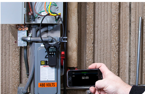
La fonction Bluetooth du CM57 permet de lire les résultats à une distance sûre
