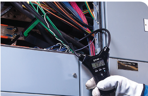
Le câble flexible du FLIR CM57 permet d'accéder aux emplacements étroits
