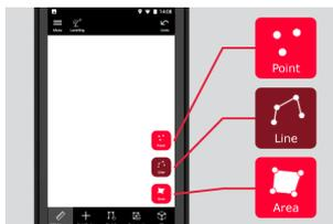
5. Pointez le laser vers la cible avec le bouton **Measure (mesure)**. Les points mesurés sont projetés sur le plan de sol et automatiquement affichés.
