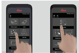
2. Sélectionnez l'option **Line (ligne)** et tracez la ligne en la glissant ou en l'effleurant. Réappuyez sur le bouton pour terminer la ligne.
