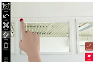
3. Effleurez le deuxième point. La distance mesurée est automatiquement affichée au-dessus de la ligne.
