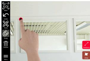
3. Effleurez d'autres points sur la photo pour définir la surface. Réeffleurez le bouton **Area (surface)** pour achever la définition de la surface.
