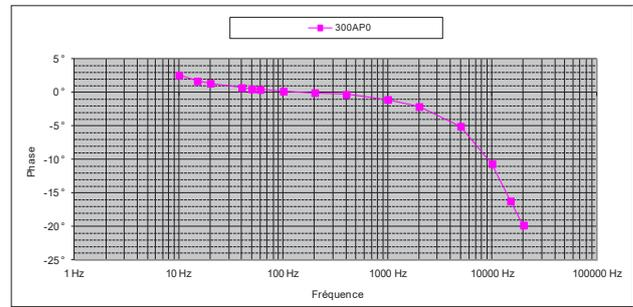
Erreur typique sur la mesure selon la fréquence pour un courant de 20 A
