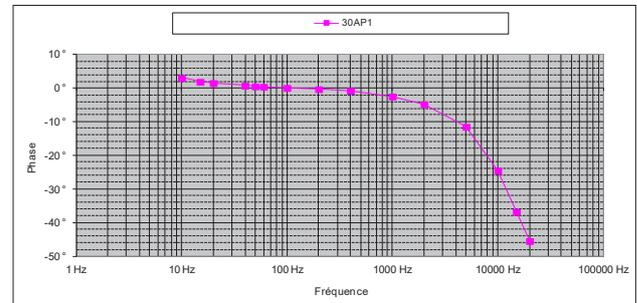
Erreur typique sur la mesure selon la fréquence pour un courant de 20 A
