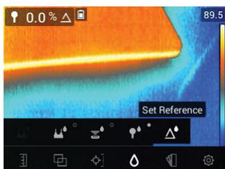
**Figure 5.20** Sélection de la valeur de référence à laquelle comparer les mesures suivantes
