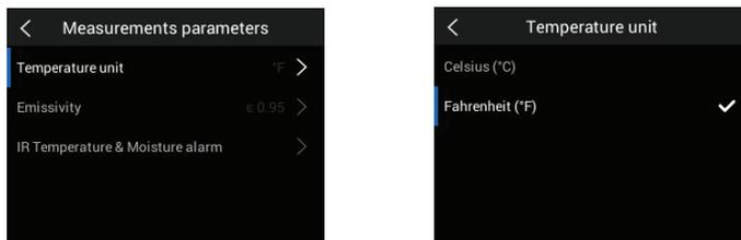
Figure 5.25 Sélection des unités de température de la mesure
