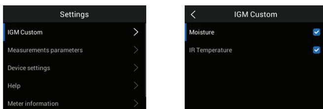
Figure 5.24 Sélections du mode Personnalisé IGM™. Sélectionnez les éléments à afficher en mode Personnalisé IGM™
