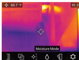
Figure 5.15 Ouverture du menu du mode Humidité
