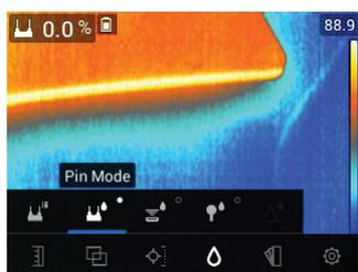
Figure 7.9 Sélection du mode Avec broche dans le menu
