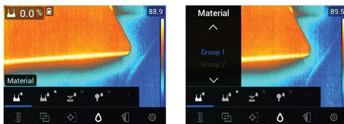
**Figure 7.8** Sélection d'un groupe de matériaux dans le menu « Humidité »
