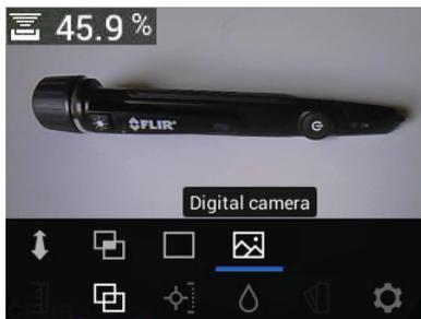
**Figure 8.3** Sélection de l'image de la caméra numérique
