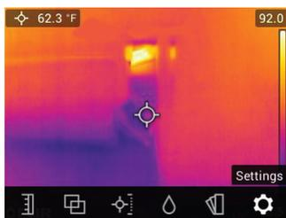
**Figure 5.1** Icônes du menu principal en bas de l'écran. Appuyez sur *Select* (Sélectionner) pour afficher les icônes.
