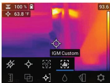
**Figure 7.7** Mode Personnalisé IGM™ avec relevés d'humidité et de température IR en haut à gauche
