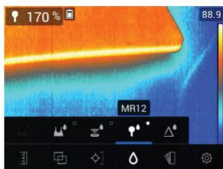
**Figure 7.11** Sélection du mode MR12 (sonde d'humidité à bille en option)
