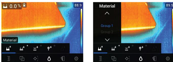
Figure 5.16 Sélection d'un groupe de matériaux pour les mesures d'humidité avec broche
