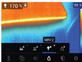
**Figure 5.19** Sélection du mode MR12 (sonde d'humidité en option)
