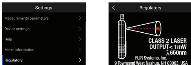
**Figure 5.37** Affichage des informations de sécurité relatives au pointeur laser
