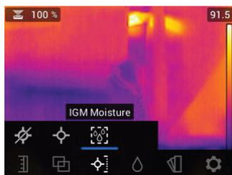
Figure 5.13 Sélection du mode Humidité IGM™ dans le menu principal
