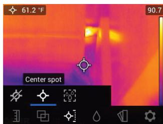
Figure 5.12 Sélection du mode « Point central » dans le menu principal
