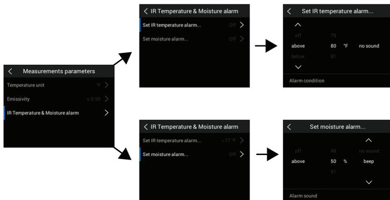
Figure 5.27 Réglage des alarmes de température IR et d'humidité
