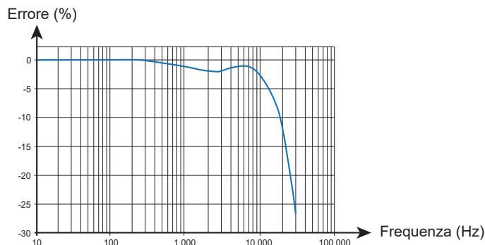
Curva tipica dell'errore di fase a 100A in funzione della frequenza
