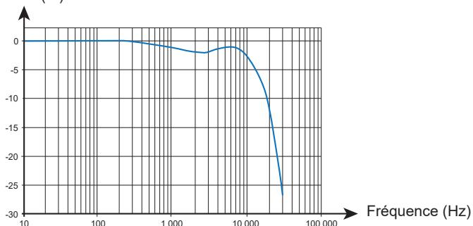
Courbe typique de l'erreur de phase à 100 A en fonction de la fréquence
