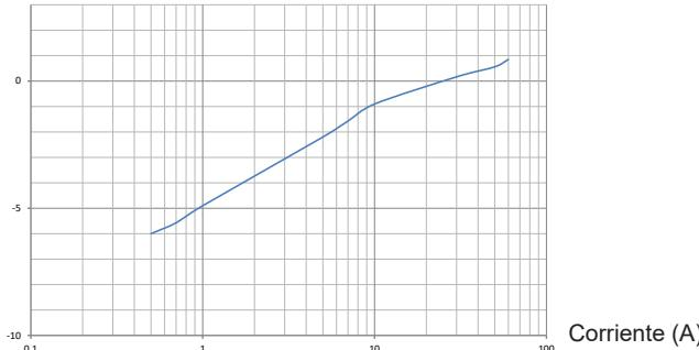
Curva típica del error de fase a 60 Hz
