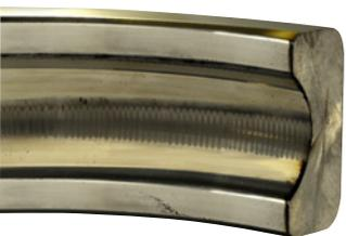
Cannelure sur une bague de roulement due aux courants de roulement (photo avec l'aimable autorisation d'Electro Static Technology).
