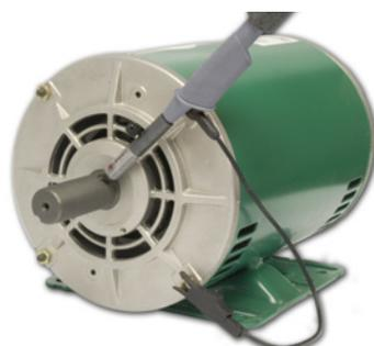
Mesure de la tension d'arbre d'un moteur avec une sonde de tension d'arbre Aegis (photo avec l'aimable autorisation d'Electro Static Technology).
