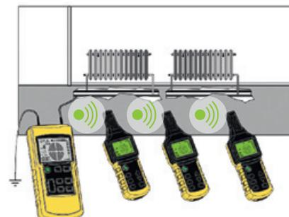
**Détection d'un tuyau métallique de chauffage**
