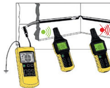
**Détection de la partie rétrécie (bouchée) d'un tuyau non métallique**
