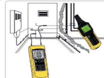
**Détection d'un tuyau métallique d'adduction d'eau**
