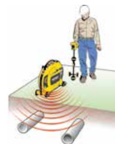
Induisez un signal pour localiser des impétrants.
