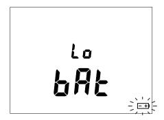
Il faut alors impérativement remplacer les piles (voir § 4.2), l'indication de l'autonomie n'étant plus fiable.
