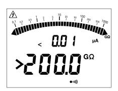
Pendant la mesure d'isolement, si la valeur à mesurer dépasse la gamme de mesure (qui dépend de l'appareil et de la tension d'essai), l'appareil le signale.
