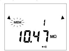
Elle est enregistrée avec toutes les informations qui s'y rattachent et qui ne sont pas forcément affichées au moment de la mise en mémoire : tension, courant, durée du test T1 et T2 dans le cas de PI et DAR, etc.
